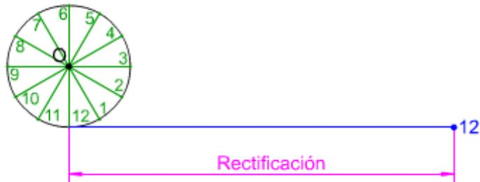
Por una de las divisiones (**12<sup>a</sup>** en el dibujo) trazamos un segmento (**012**) tangente a la circunferencia de longitud igual a su rectificación, el extremo **12** es el primer punto de la envolvente.
